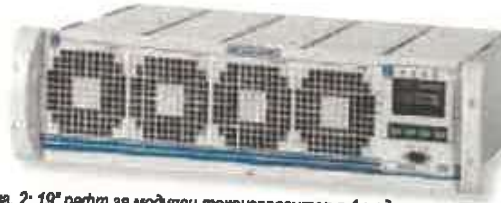
Фиг. 2: 19" рафт за модулна токоизправител с 4 модула TEBESOP 3000 I и дистанционен блок за мониторинг MCU 2500 изходно напрежение 110 V, изходен ток 80 A
