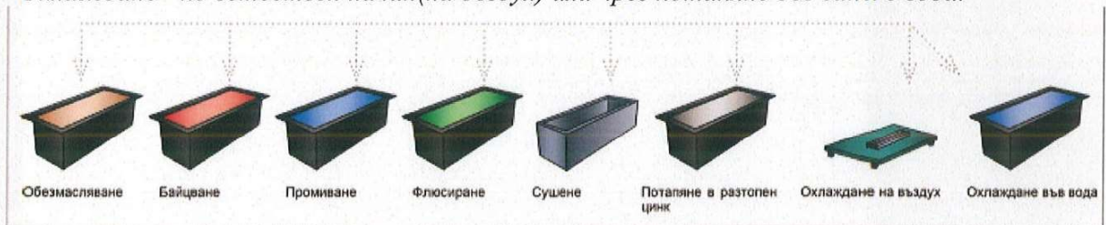
Фигура 1. Производствен цикъл в групата заводи "ЗГП-ЗАВОДИ ЗА ГОРЕЩО ПОЦИНКОВАНЕ"
